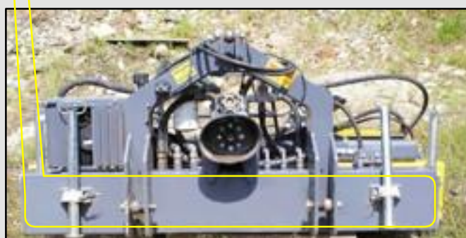
Tanque de aceite con una capacidad de 95 litros
