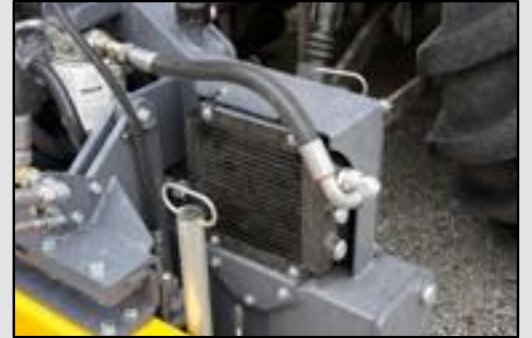
Refrigerador de aceite independiente con ventilador y revestimiento de chapa
